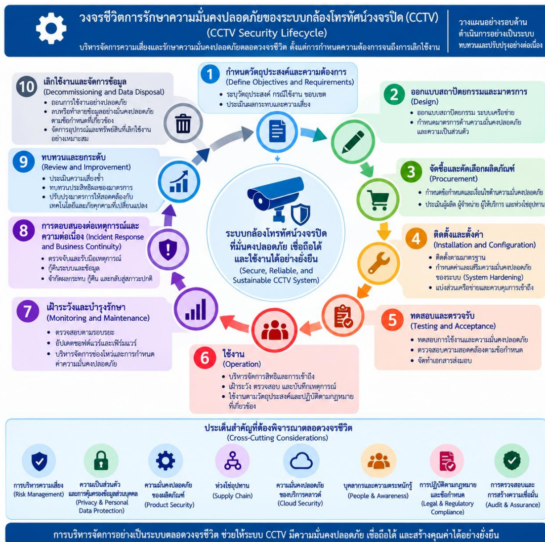
รูปที่ 3 วงจรชีวิตความมั่นคงปลอดภัยของระบบ CCTV (CCTV Security Lifecycle)
