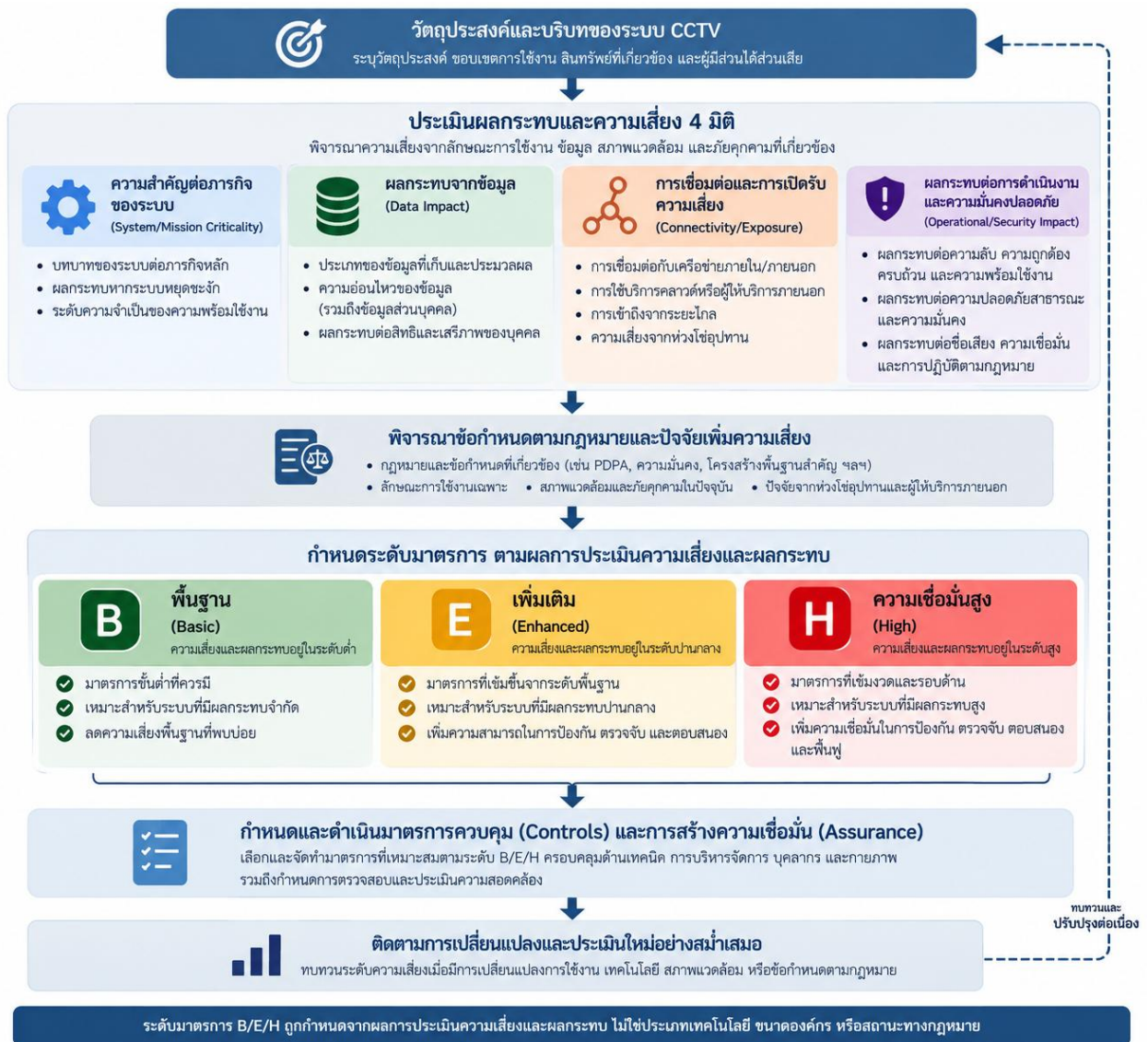
รูปที่ 2 กรอบการประเมินผลกระทบและความเสี่ยงเพื่อกำหนดระดับมาตรการรักษาความมั่นคงปลอดภัยของระบบ CCTV
